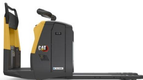
Les versions à plateforme fixe avec entrée latérale NPF20N3S et NPF25N3S sont parfaites pour la préparation des commandes et autres applications internes. Tandis que l'ensemble des modèles NPV et NPF sont dotés d'une suspension confortable, les plates-formes fixes offrent aussi, en option, des réglages électriques en fonction du poids de l'opérateur et de ses préférences.
